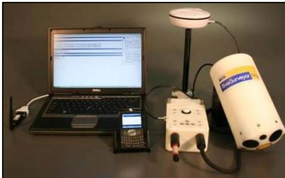
Figura 3 Hardware montado para a opção D-GPS com comunicações bluetooth.
